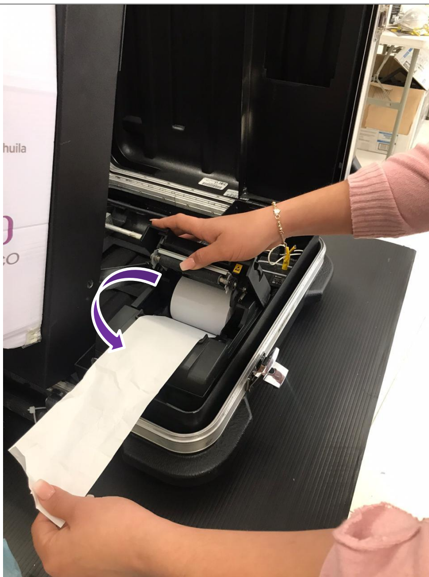
Introducción de rollo dejando un pequeño excedente de papel fuera de la cubierta.
